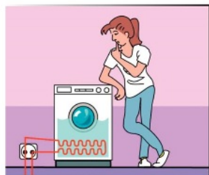
6.21a De stroom loopt door het verwarmingselement. De rode lijn geeft de weg aan die de stroom volgt.
