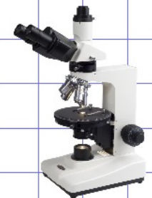
optische microscoop maximale vergroting: 1000\times maximale resolutie: 200 nm
