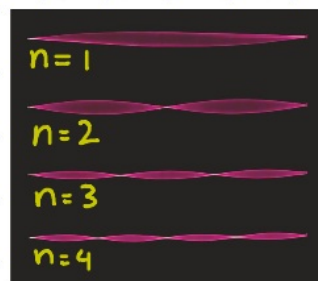
▲ Figuur 19.29 Staande golven in een snaar
