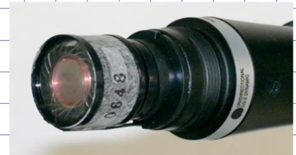
▲ Figuur 10.51 Dynamische microfoon
