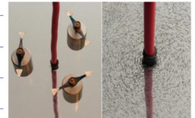
▲ Figuur 10.18 Veldlijnen rond een stroomdraad
