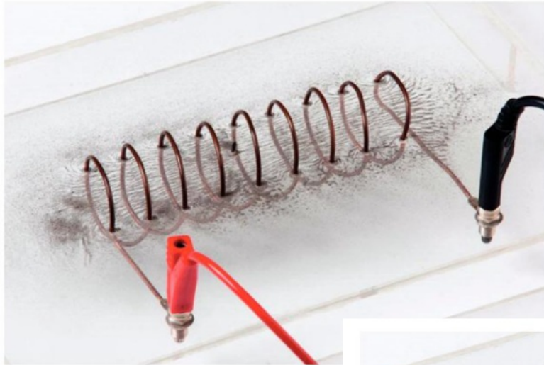
▲ Figuur 10.20 Magneetveld van een spoel
